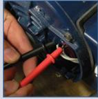
Con el motor en funcionamiento, utilice un voltímetro para comprobar si el voltaje de línea que ingresa al motor es la misma que la indicada como salida de la caja del interruptor.
